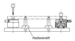
Gleichzeitiges Spannen und Positionieren eines Werkstücks
